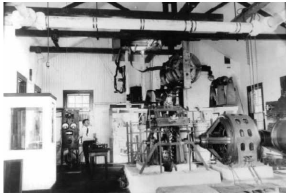
trasmettitore con spinterometro rotante e modulazione sul circuito di antenna
